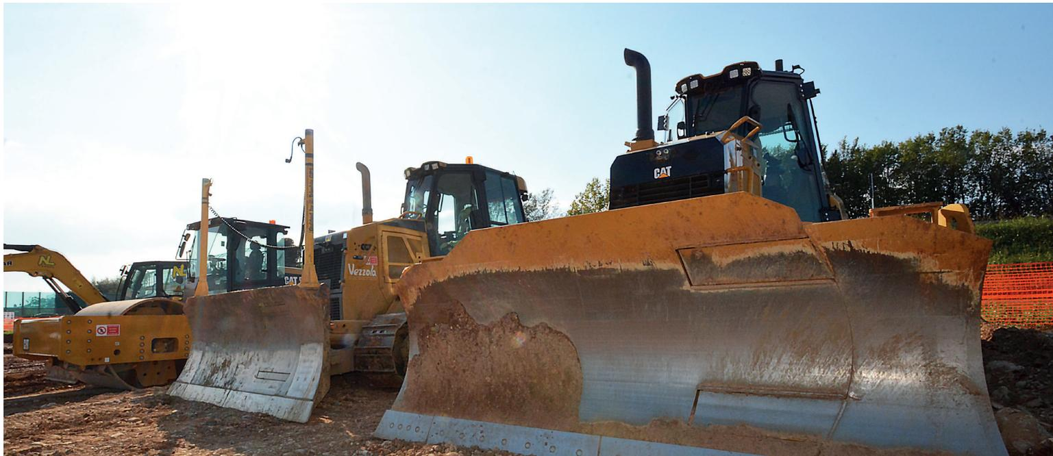
Le opere di movimento terra hanno richiesto l'impiego intenso di bulldozer Cat®, tutti con sistemi 3D
